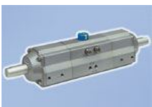
3-х позиционные пневмоприводы с промежуточной регулируемой позицией: двойного действия с величиной поворота выходного вала 90°, 120°, 180° одностороннего действия с величиной поворота выходного вала 90°
