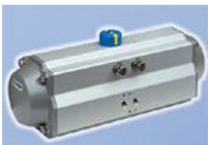
3-х позиционные пневмоприводы с промежуточной регулируемой позицией: двойного действия с величиной поворота выходного вала 90°, 120°, 180° одностороннего действия с величиной поворота выходного вала 90°
