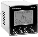
**pH-4122** – двухканальный pH-метр, в состав которого входят два первичных преобразователя (как у pH-4121) и двухканальный измерительный прибор с графическим дисплеем, архивом, интерфейсом, аналоговыми и дискретными выходными сигналами. Градуировка каждого канала по буферным растворам производится в первичных преобразователях (как у pH-4121).
