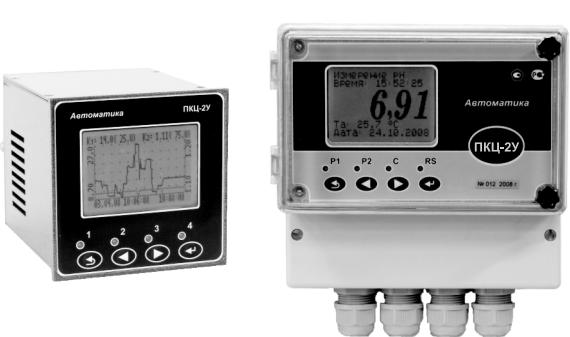
Прибор предназначен для работы в комплекте с одним или двумя первичными преобразователями (ПП). В качестве ПП применяются трансмиттеры: для измерения активности ионов водорода (рН) или окислительно-восстановительного потенциала (ОВП) - типа pH-4101, для измерения удельной электрической проводимости (УЭП) или концентрации контактным и бесконтактным датчиками - типа АЖК-3110 и АЖК-3130.
