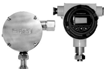
**pH-4101** – pH-трансмиттер, который может быть использован в измерительных комплексах при наличии гальванически изолированных входов и источников питания постоянного тока 24 В. Трансмиттер обеспечивает измерение pH в заданном диапазоне и преобразование измеренных значений в унифицированный аналоговый сигнал 4...20 мА.
