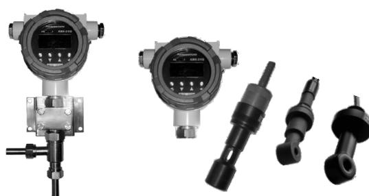
**АЖК-3110 и АЖК-3130** - кондуктометры-трансмиттеры, которые питаются напряжением постоянного тока (12...36) В и обеспечивают формирование унифицированных выходных сигналов постоянного тока или имеют выходной интерфейс RS-485 с протоколом обмена ModBus.
